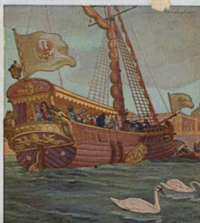
BILD 136: LUSTYACHT. Die Schiffe der Barockzeit waren breit und schwer gebaut bei nur geringem Tiefgang. Den sog. Gallion, den konsolartigen vorderen Ausbau, schmückte meist eine geschnitzte Gallionsfigur oder ein reich verziertes Wappen. Im Gegensatz zu den Kriegs- und Handelsschiffen ist die Lustyacht nur ein mit einem Verdeck versehenes einmastiges Schiff, das besonders bei höfischen Festen diente.
