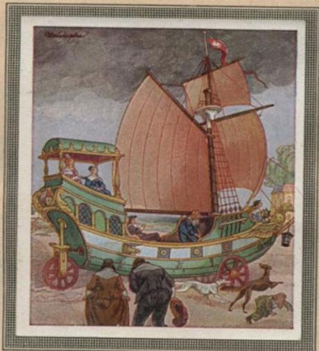
BILD 115: SEGELWAGEN. Der Segelwagen ist eine zuerst im 16. Jahrh. auftauchende technische Erfindung, die die Kraft des Windes dem Fahren auf dem Lande nutzbar machen wollte durch ein Segelschiff auf Rädern. Dieser „Lustwagen“, nur zu Fahrten am Ufer benutzbar, war mehr eine fürstliche Liebhaberei. Praktische Verwertung hat das gleiche Prinzip erst bei den auf Kufen laufenden Segelschlitten erlangt.
