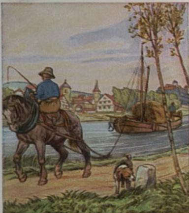
BILD 239: TREIDELSCHIFF. Stromaufwärts wurden große Lastlähne durch Treideln vorwärts bewegt, d. h. mit Hilfe einer an Mast oder Bug befestigten Leine von Menschen oder Pferden, die auf dem neben dem Wasser entlang führenden Treidelweg gingen, vorwärts gezogen. Heute im Zeitalter der Elektrizität und des Motors ist das Treideln mit Menschen- und Pferdekraften ein seltener Anblick geworden.
