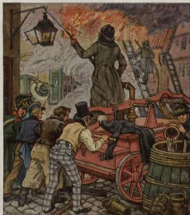
BILD 227: FEUERSPRITZE MIT HANDBETRIEB. Bis Anfang des 19. Jahrh. wurde das Pumpwerk der Feuerspritze noch durch menschliche Kraft in Bewegung gesetzt. Um die Arbeitsleistung zu steigern, ersetzte man die Handfeuerspritze durch eine mit Dampf oder einem Motor betriebene, die Kosten ersparte und schneller arbeitete. Als Wasserspeicher dienten große auf Rädern oder Kufen gleitende Wassertonnen.
