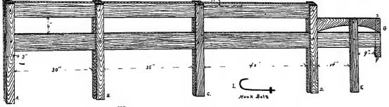
FIG. 293-WAGON BACK AND STANCHION (SHOWING BACK).
