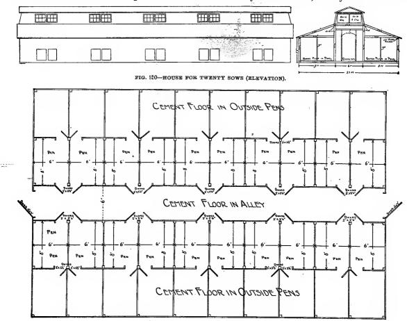
FIG. 151-HOUSE FOR TWENTY SOWS (FLOOR PLAN).
