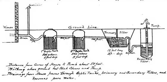
FIG. 321-FARM DRAINAGE SYSTEM.
