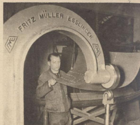
Beim Walzen der Motorhaube wird das Leichtmetallblech unablässig zwischen den glatten Walzen hin und hergezogen
