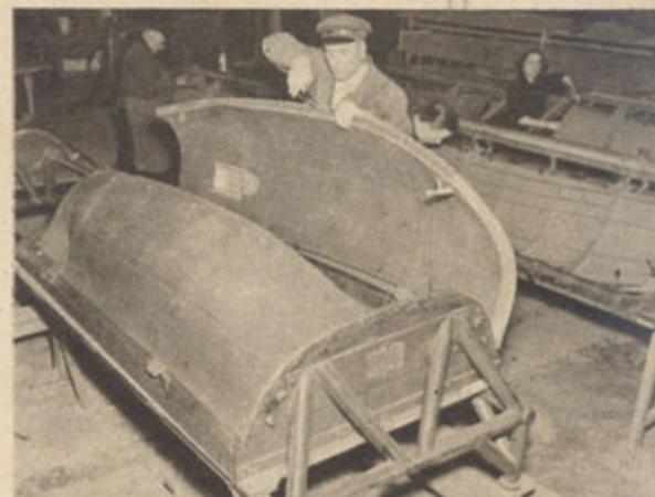
Das Leichtmetallblech formt sich zur Motorhaube. Auf kleinen Hellingen wird die Form montiert und vernietet
